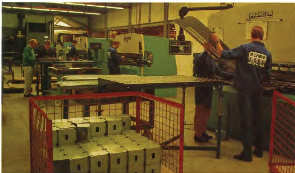
**Ein exakter Zuschnitt** per Laser oder Revolverstanze erleichtert auch die Arbeit an der CNC-Abkantpresse. Das Probieren mit verschiedenen Biegeradien gehört der Vergangenheit an. Bilder: Sorba
