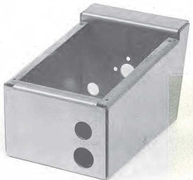
Darstellung des gebogenen Zuschnitts, die bis ins Detail dem späteren Werkstück gleicht. Bilder: Sorba
