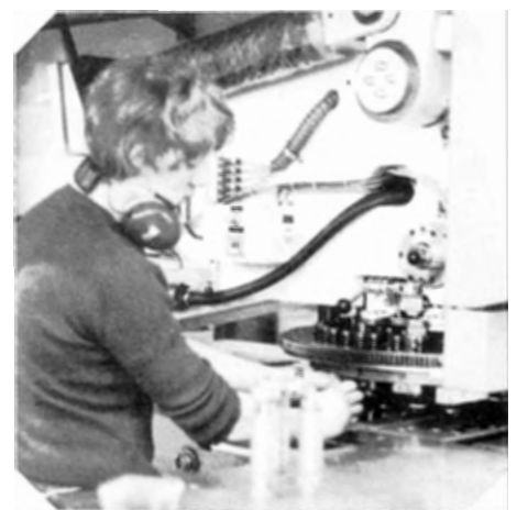
Instellen van gereedschappen in pons-nibbelmachine.
